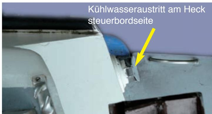
Um sicher zu sein, dass während der Fahrt auch gekühlt wird, braucht Ihr nur an der Steuerbordseite, während die Maschine läuft, achtern (hinten) am Boot raus sehen. Dort muss das von erwärmte Wasser aus dem Auspuff kommen. Sollte das nicht der Fall sein, hat die Kühlwasserpumpe einen Schaden, der behoben werden muss, bevor die Fahrt weitergeht.
