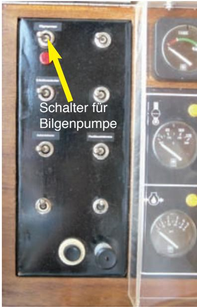
Über einen Schlauch wird das Gemisch in einen Kanister gepumpt, der sich hinter der Maschine beim Getriebe befindet. Bitte mindestens einmal täglich kontrollieren (Eintrag ins Logbuch). Solch ölhaltiges Wasser kann meist an den Bunkerstationen abgegeben werden. **Auf keinen Fall das Gemisch ins Wasser oder an Land gießen. Es wäre eine teure Straftat** und mal ehrlich: wer möchte schon in dreckigem Wasser fahren oder an Land das Grundwasser verseuchen.
