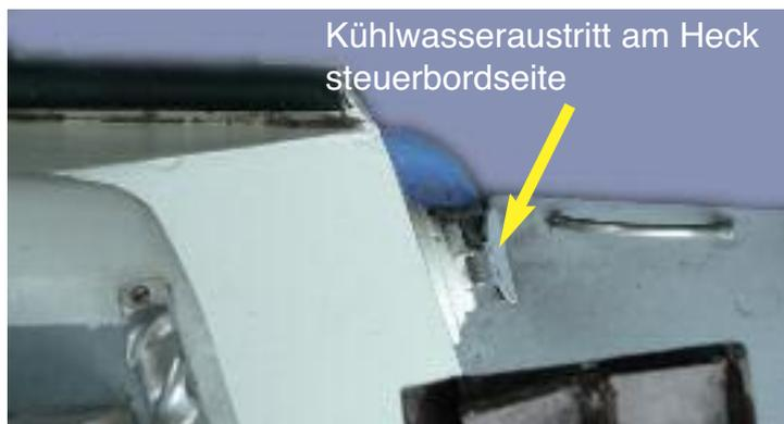
Um sicher zu sein, dass während der Fahrt auch gekühlt wird, braucht Ihr nur an der Steuerbordseite, während die Maschine läuft, achtern (hinten) am Boot raus sehen. Dort muss das vom motor erwärmte Wasser aus dem Auspuff kommen. Sollte das nicht der Fall sein, hat die Kühlwasserpumpe einen Schaden, der behoben werden muss, bevor die Fahrt weitergeht.
